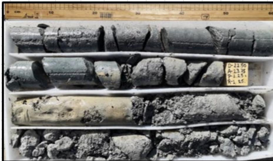
Fotografía 10. Lutitas y limolitas disgregadas y fracturadas en el sondeo PC-20 (SEG-DGL-K1330-I-1024/06-0621).
