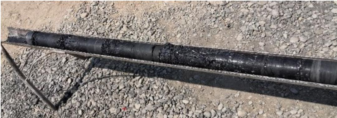
Fotografía 14. Carbón, a la profundidad de 141,88 a 146.55 metros, en el sondeo PCT-1 (SEG-DGL-K1330-I-029/06-0621).
