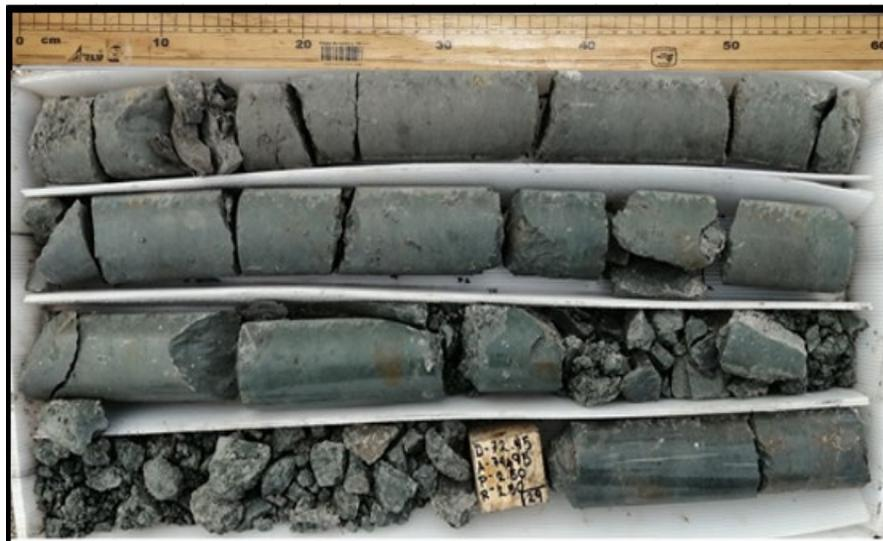
Fotografía 11. Limolita-Lutita con zona de disgregación y agrietamiento. Muestra del Sondeo PC-13B (SEG-DGL-K1330-I-017/06-0621).
