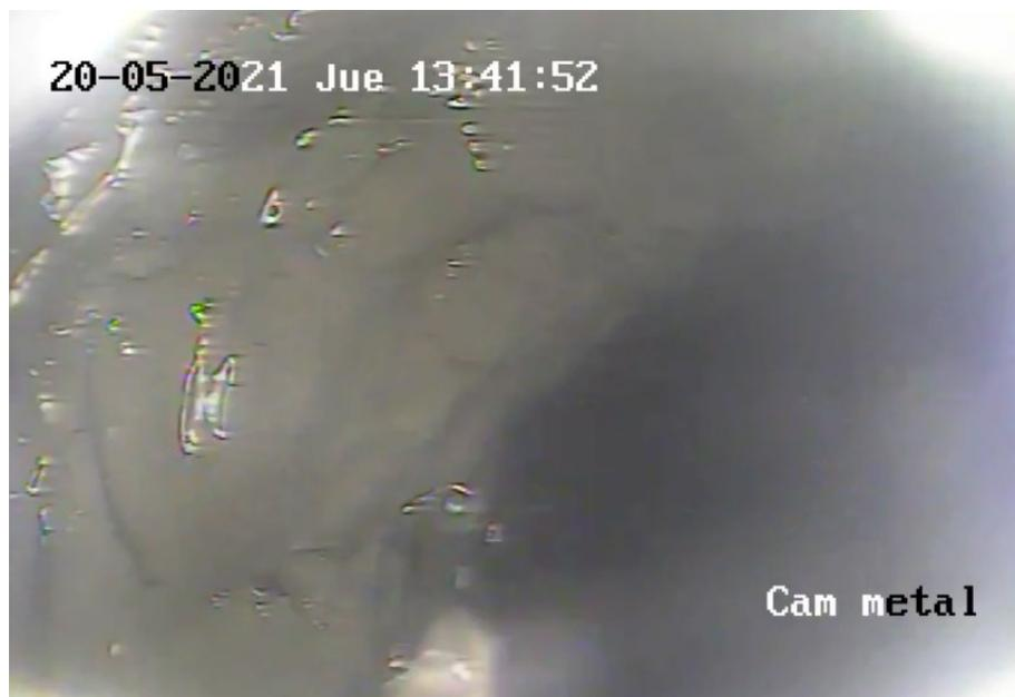
*Fotografía 22. Paredes irregulares, con fragmentos de roca suelta.*
