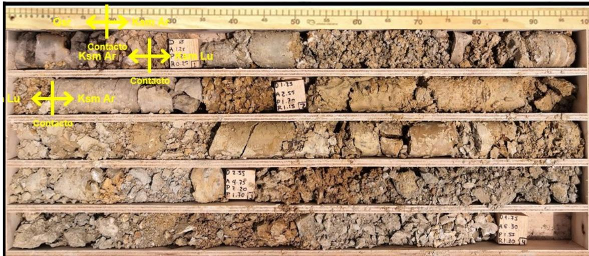
Fotografía 6. Suelo residual y los primeros metros de la Formación Escondido (Arenisca y lutita), con un grado de meteorización que va de IV a V. Muestra del sondeo PCT-1 (SEG-DGL-K1330-I-029/06-0621).
