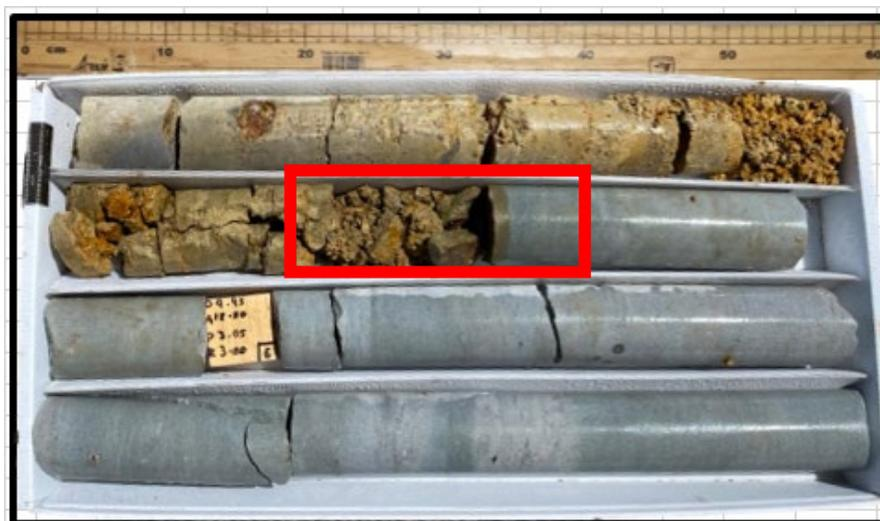
Fotografía 7. Contacto entre la zona meteorizada y la arenisca sana. Sondeo PC-15 (SEG-DGL-K1330-I-019/06-0621).
