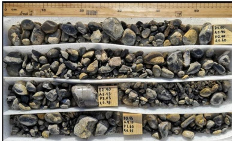
Fotografía 2. Material Aluvial, recuperado del sondeo PC-20 (SEG-DGL-K1330-I-024/06-0621).
